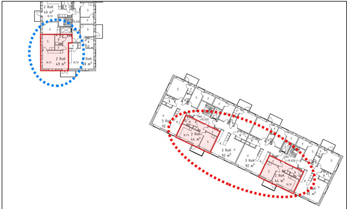
Figur 9. Rödmarkerade lägenheter bör förses med åtgärder. Det avser enkelsidiga lägenheter på plan 1-4 i den södra delen mot fotbollsplanen (inom röd streckad ellips) samt tvårumslägenheten i den västra gaveln (plan 4 och uppåt) som påverkas av buller från båda fotbollsplanerna (inom blå streckad ellips). På övriga våningsplan i den västra delen skärmar gymnastikhallen buller från den västra fotbollsplanen.
