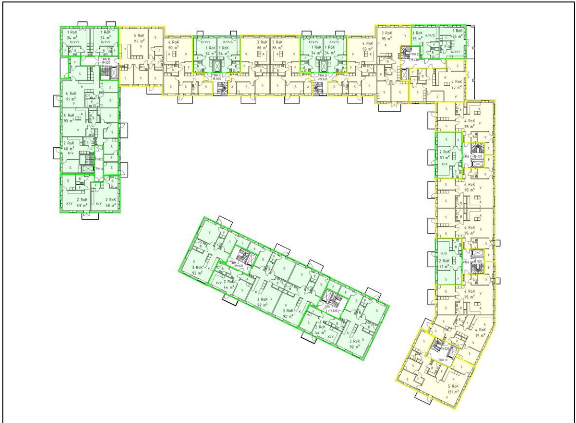
Figur 7. Plan 4 (normalplan, daterat 2025-12-04). Samtliga lägenheter klarar trafikbullerförordningens, antingen genom att minst hälften av bostadsrummen är orienterade mot en luddämpad sida (gulmarkerade lägenheter), eller genom att högst 60/65 dBA dygnsekvivalent ljudnivå beräknas (grönmarkerade lägenheter). Principen är samma på resterande våningsplan.
