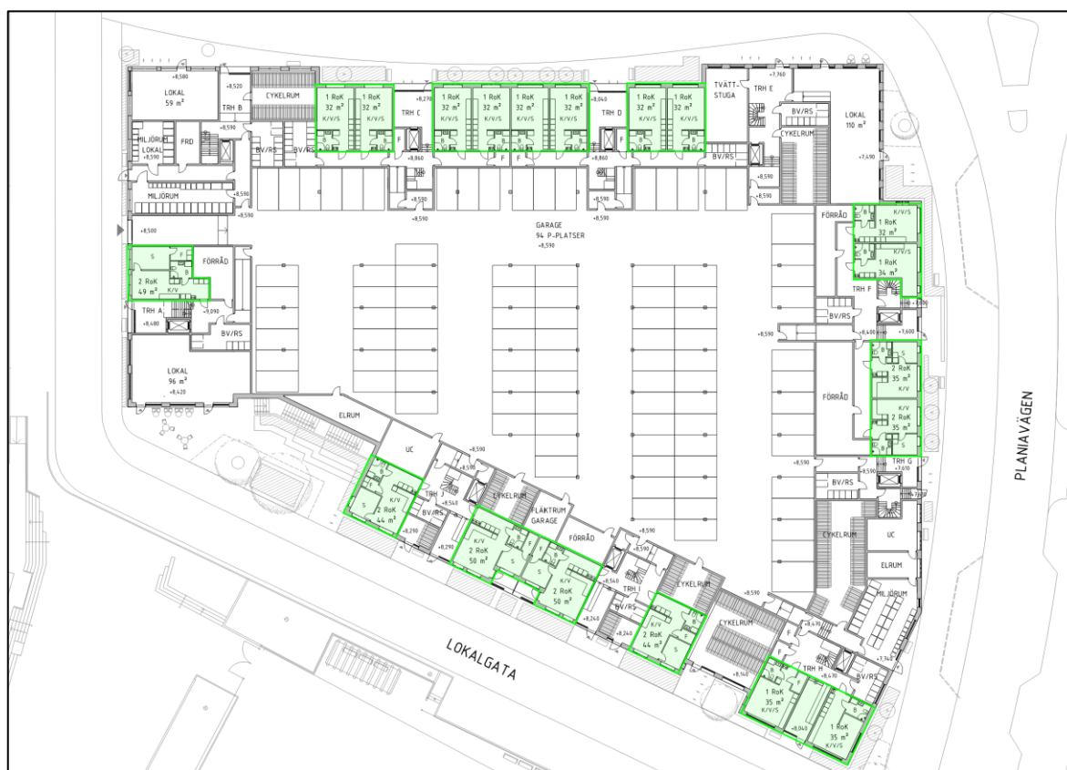
Figur 6. Plan 1 (entréplan, daterat 2025-12-04). Samtliga lägenheter klarar trafikbullerförordningens, se gröna markeringar. Enkelsidiga lägenheter mot Järlaleden och Planiavägen är högst 35 \text{ m}^2 .
